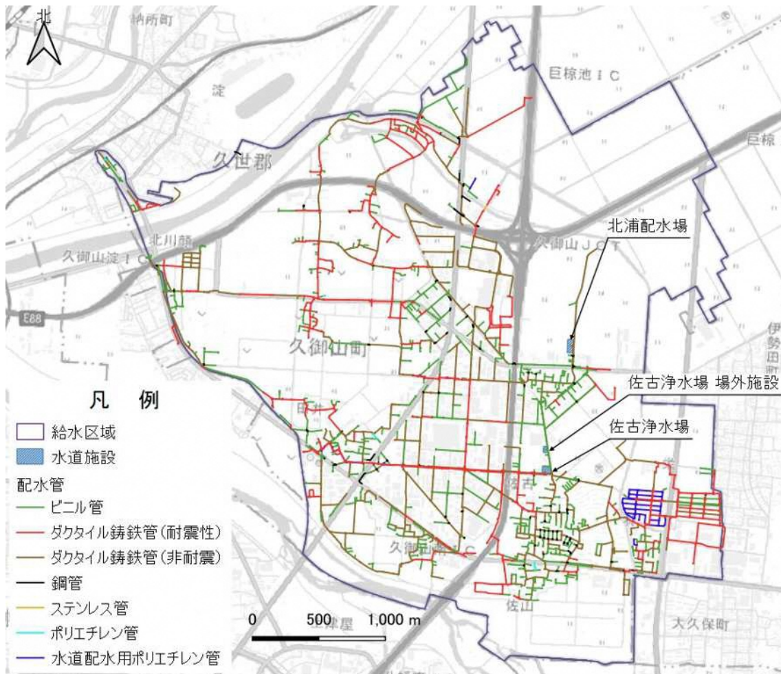
図 2.8 久御山町水道施設配置図 (令和 4 年度末)
